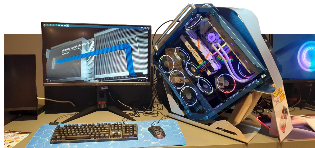
Galaxy: computer montato in un case artigianale e fabbricato in serie limitata per un pubblico esclusivo con caratteristiche uniche: peso del case 25Kg, acciaio da 3mm, alluminio, vetro temperato e verniciatura gommata.
